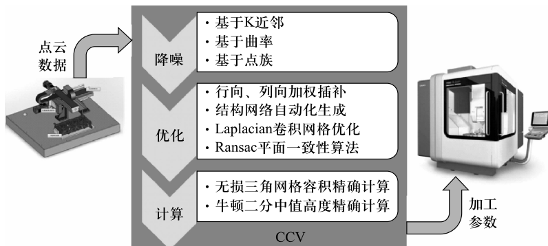
图 23 缸盖燃烧室容积检测系统流程
