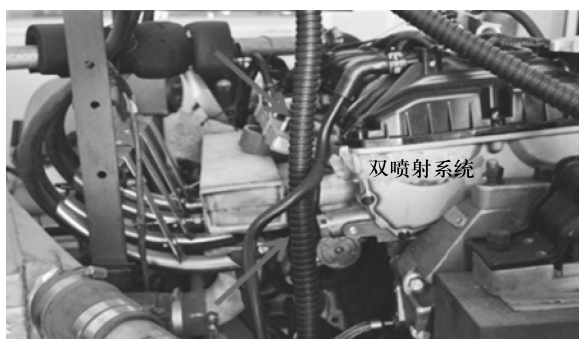
图 16 汽油机双燃料喷射系统
