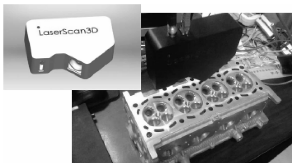
图 22 缸盖燃烧室容积光学测量设备
